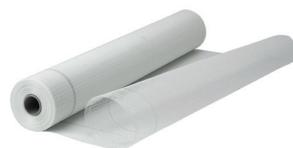
• Malla de fibra de vidrio con tratamiento superficial de elevada resistencia a los álcalis especialmente indicada en la aplicación de yesos en interior. También puede ser utilizada en aplicaciones de microcemento y como refuerzo en gresites y mosaicos. Garantiza la estabilidad de los soportes favoreciendo una excelente resistencia a posibles fisuras.
